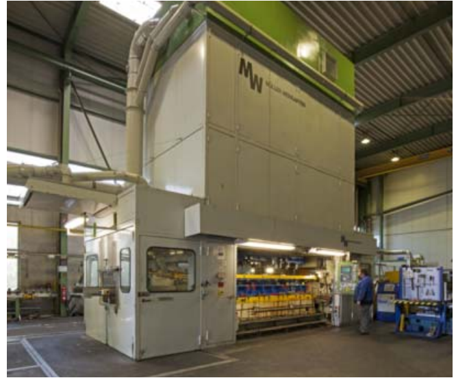
Stanzautomat mit 630 Tonnen maximaler Presskraft.
