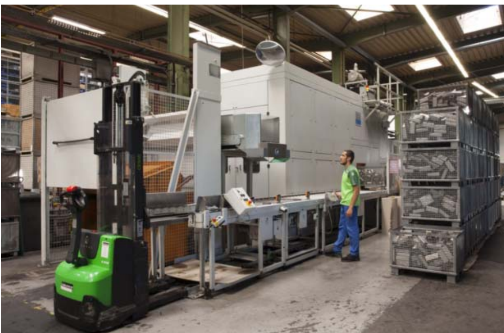
Im Bild eine PER-Entfettungsanlage für Stanzteile. Nach der Reinigung ist eine Rückfettung der Teile möglich.
