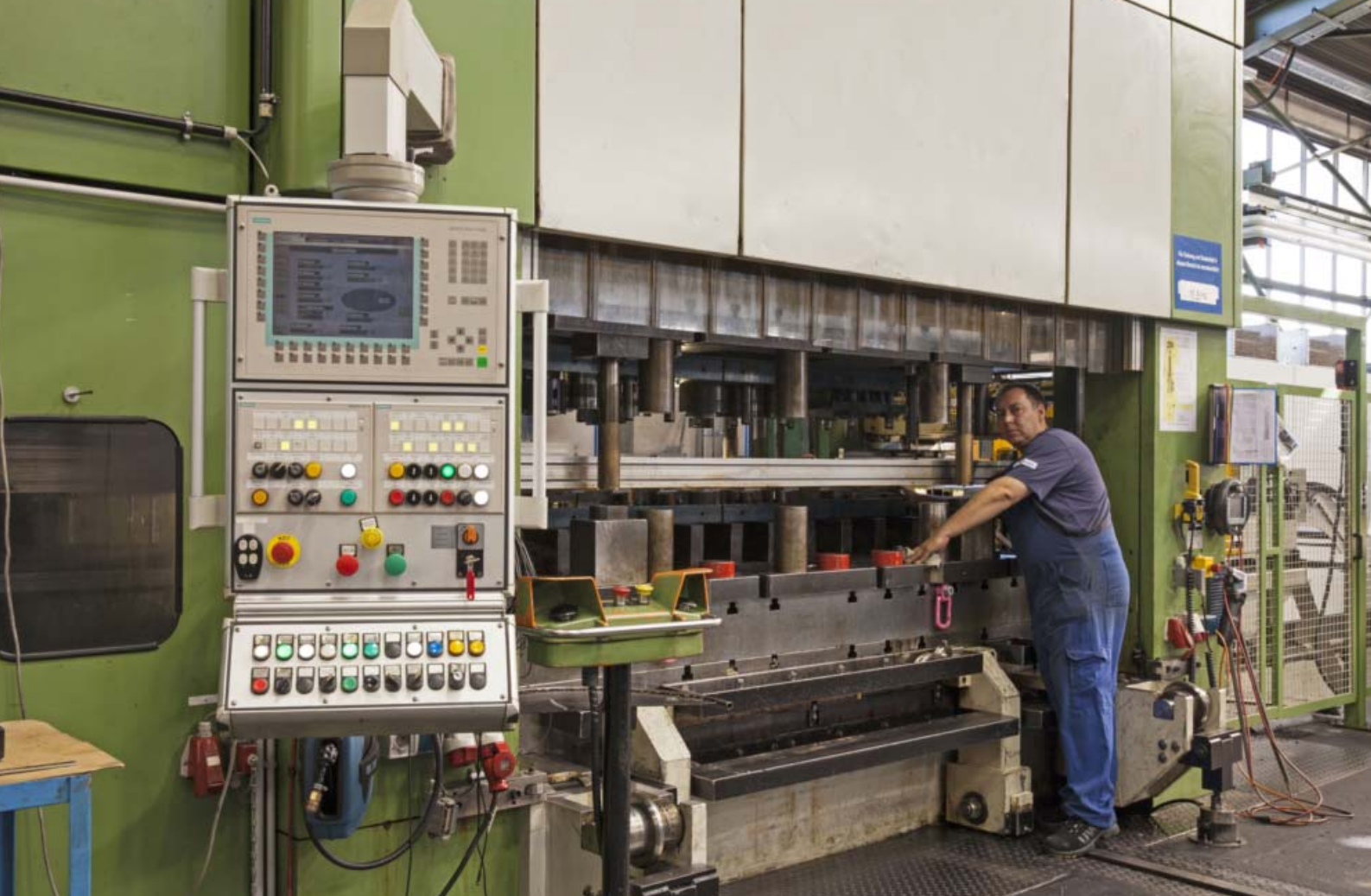
500-Tonnen Stanzautomat mit elektronischem Transfer für die Herstellung von Automobilteilen.
