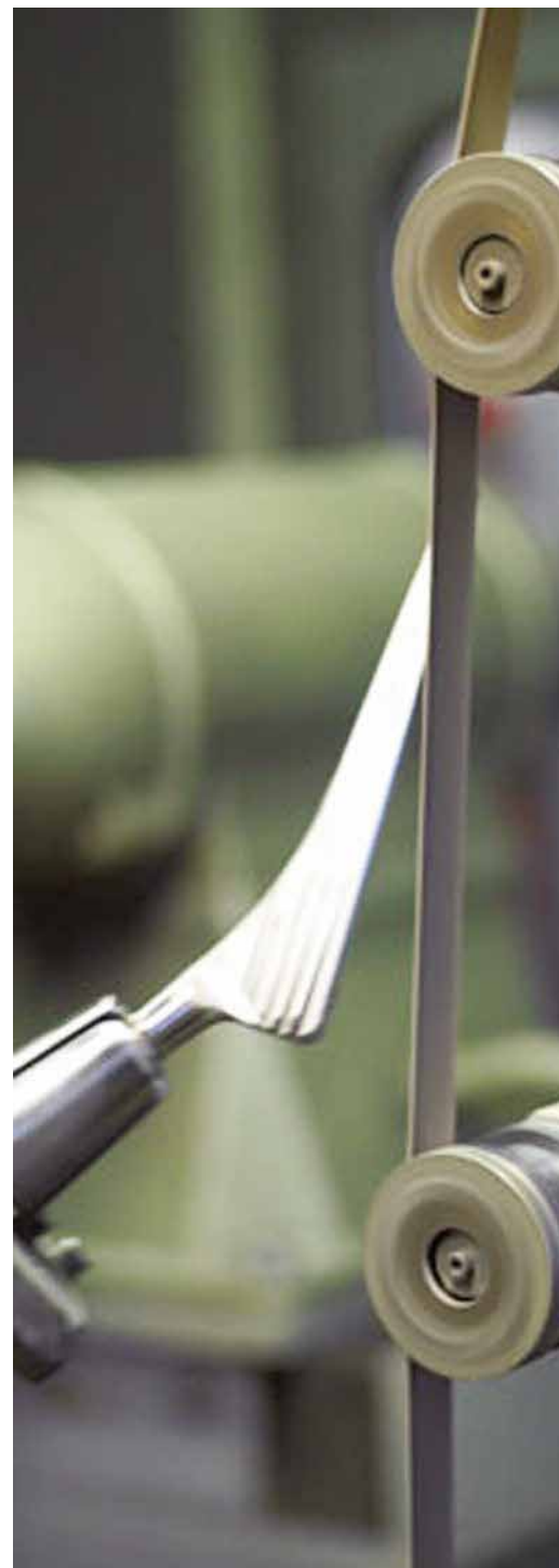
Roboterschleifen mit VSM KK712F
