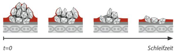
VSM COMPACTGRAIN Serien bestehen aus Granulaten, die zahlreiche Schleifkörner beinhalten. Verbrauchte Schleifkörner werden durch die Schleifkräfte herausgebrochen und legen unverbrauchte scharfe Kornspitzen frei.
