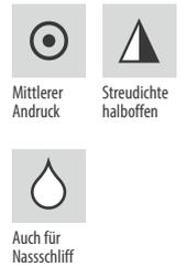
Neueste Generation von Langzeitschleifmitteln mit kontinuierlichem Selbstschärfungseffekt und reduzierten Schleifkosten durch weniger Werkzeugwechsel. Ein beständiges und gleichmäßiges Abnutzungsverhalten führt durch die halboffene Streudichte insbesondere bei Flachsleifanwendungen zu einem einheitlicheren Schliffbild sowie einer gleichmäßigeren Oberflächenrauigkeit über die gesamte, sehr lange Standzeit.
