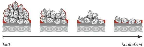
Bei den **VSM COMPACTGRAIN Plus** Serien führen eine optimierte Kornreserve sowie verbesserte Bindungseigenschaften zu einer gleichmäßigeren Abnutzung. So kann das Granulat bis auf das Trägermaterial vollständig genutzt werden.
