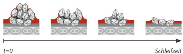
VSM COMPACTGRAIN Serien bestehen aus Granulaten, die zahlreiche Schleifkörner beinhalten. Verbrauchte Schleifkörner werden durch die Schleifkräfte herausgebrochen und legen unverbrauchte scharfe Kornspitzen frei.
