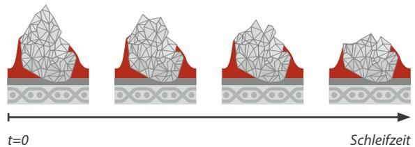
Aufgrund der optimierten, mikrokristallinen Kornstruktur der **VSM CERAMICS Plus** Serien baut sich das Keramik Korn beim Schleifprozess definiert ab und erzeugt dadurch immer wieder neue, scharfe Schneidkanten.
