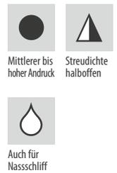
Keramikkorn-Schleifmittel mit Selbstschärfungseffekt überzeugt bei der Bearbeitung sehr harter Oberflächen durch einen aggressiven Schliff und sehr lange Standzeiten. Die schleifaktive Zusatzschicht TOP SIZE reduziert zudem die Temperatur in der Schleifzone.
