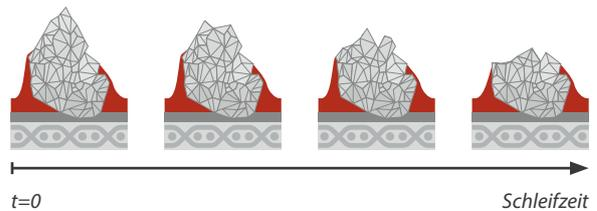
Aufgrund der optimierten und so feineren, mikrokristallinen Kornstruktur der **VSM CERAMICS Plus** Serien baut sich das Keramik Korn beim Schleifprozess definiert ab und erzeugt dadurch immer wieder neue, scharfe Schneidkanten.
